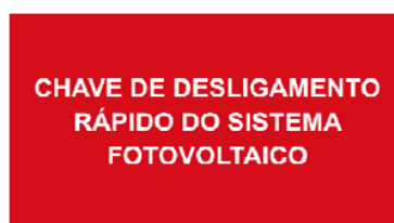
Figura 03 – Sinalização da Chave de Desligamento Rápido para Sistemas Tipo 2 e 3
