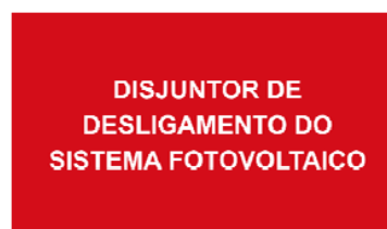
Figura 02 – Sinalização do Disjuntor de Desligamento para sistemas do tipo 1.
